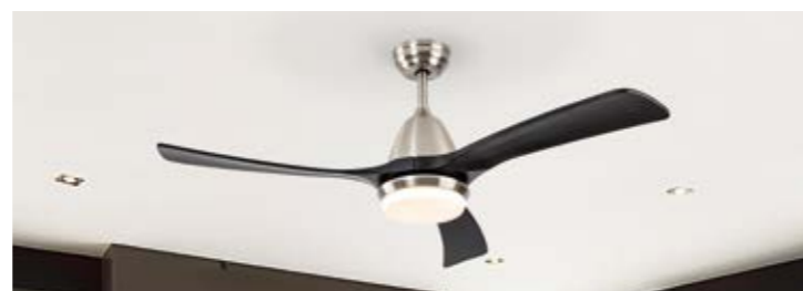
316545 LED 20W / 1.700 lumen / CCT 3.000 - 4.000 - 5.000 K Motor / motor fan DC 28W Hélice de 3 aspas / 3-blade fan Ø132 cm 6 velocidades / 6-speed (100/120/140/160/180/200 rpm), reversible / reverse Emisión de ruido: máxima 50 db / Noise emission: maximum 50 db
